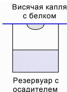
Рис. 6.3. Выращивание кристалла методом висячей капли.
